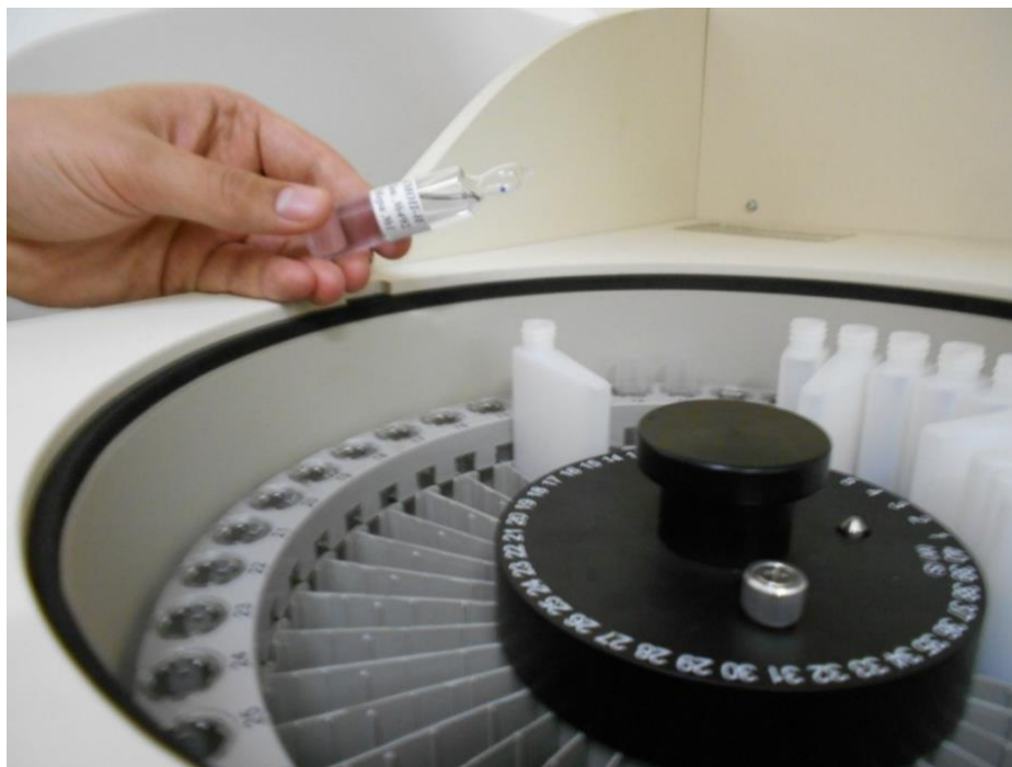
3.4 - сурет – Вакуумдық түтіктердің нақты көлемін анықтау процесі
